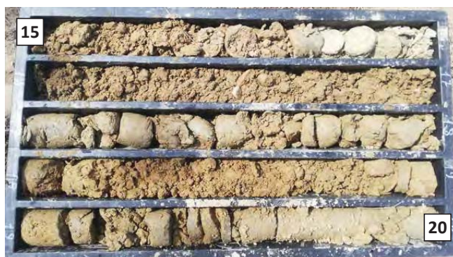
UNIVERSITA' DEGLI STUDI DI PAVIA Nuovo Parco per l'Innovazione "Girolamo Cardano" – Loc. Cravino SONDAGGIO S1 Cassetta da 15.00 a 20.00m
