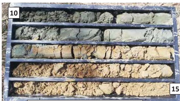
UNIVERSITA' DEGLI STUDI DI PAVIA Nuovo Parco per l'Innovazione "Girolamo Cardano" – Loc. Cravino SONDAGGIO S1 Cassetta da 10.00 a 15.00m
