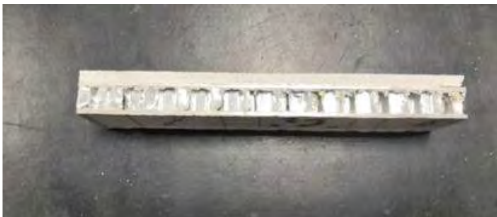
Figura 3.10: Pannello in pietra composita a struttura sandwich (con supporto alveolare in alluminio).
