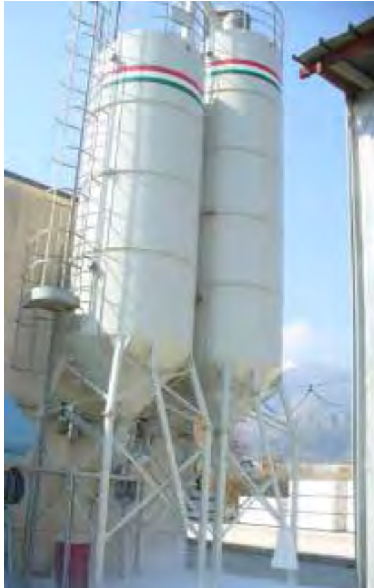
Figura 3.16: tramogge contenenti sabbia e cemento.
